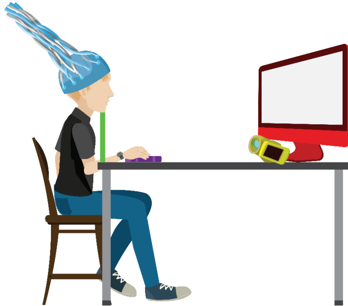
Figura 3 – Esquema de disposición de implementos para realización de la tarea.- Los voluntarios se encontraban sentados en una silla a una distancia de 70 cm del monitor (rojo). Bajo el monitor se dispone el sistema de seguimiento ocular EyeTracker (amarillo). Para evitar que los sujetos varíen la distancia de su rostro con el monitor, debían apoyar la cabeza sobre una mentonera (verde). En paralelo los electrodos del EEG (celestes) son levantados para evitar el peso sobre la cabeza y que no se dañen. Finalmente, el sujeto reportaba sus respuestas por medio de una botonera (morado) que fue alternada de mano entre sujetos.
