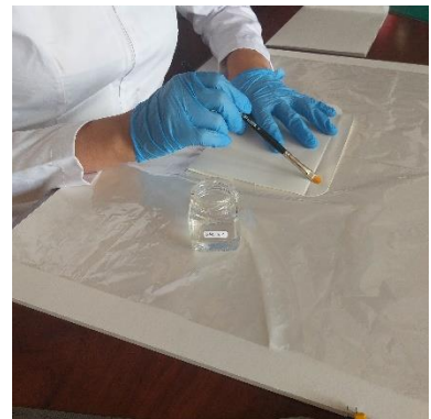
Imagen 60: Colocación del CMC sobre las lengüetas.
