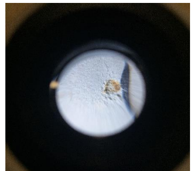
Imagen 115: Retiro de depósitos de óxido.
