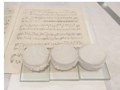
Imagen 111: Colocación de papel secante, vidrios y peso sobre el injerto, para que se seque y se alise.
