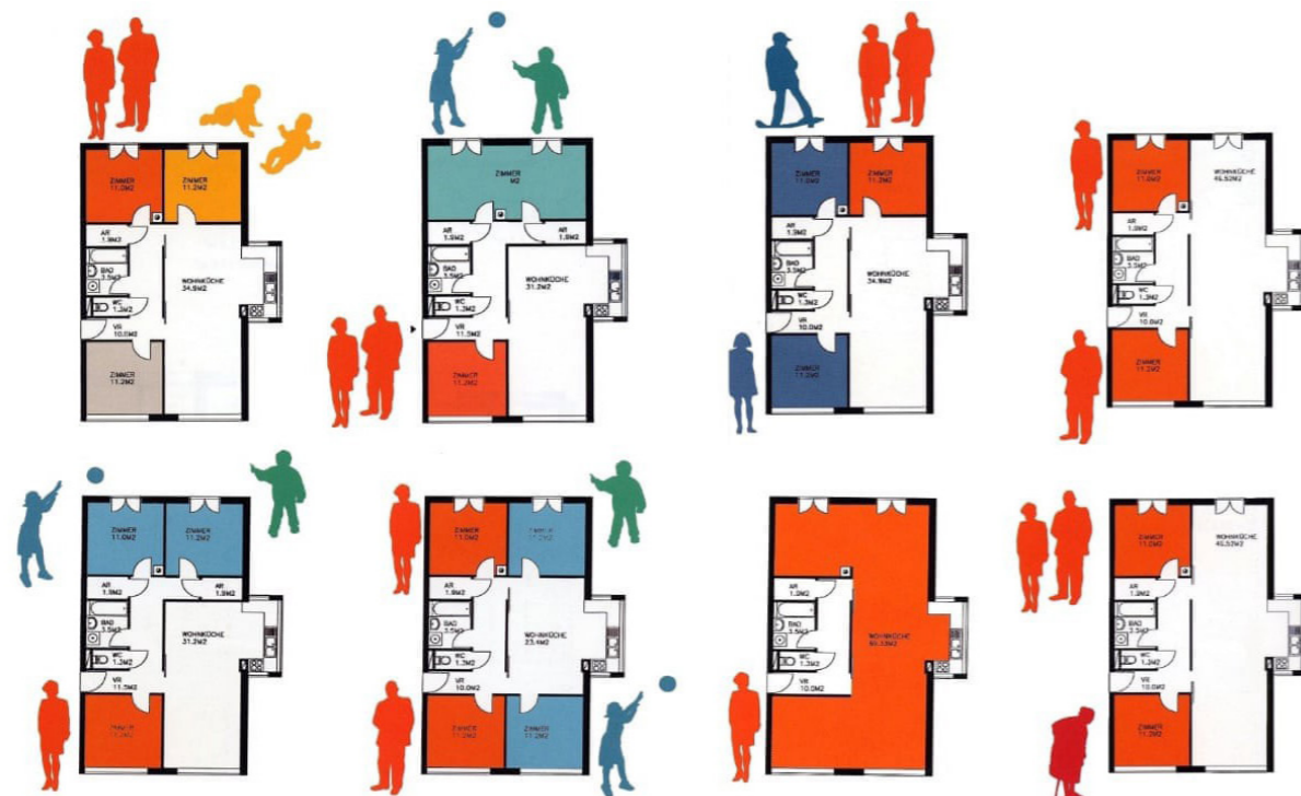
Fig. 9. Plantas flexibles con las etapas de la vida, proyecto Frauen-werk-stadt I Fuente: Palit (2019)
