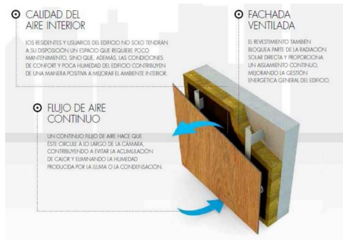
Ejemplo de funcionamiento del material TRESPA en fachadas de hormigón. Fuente: trespa.com
