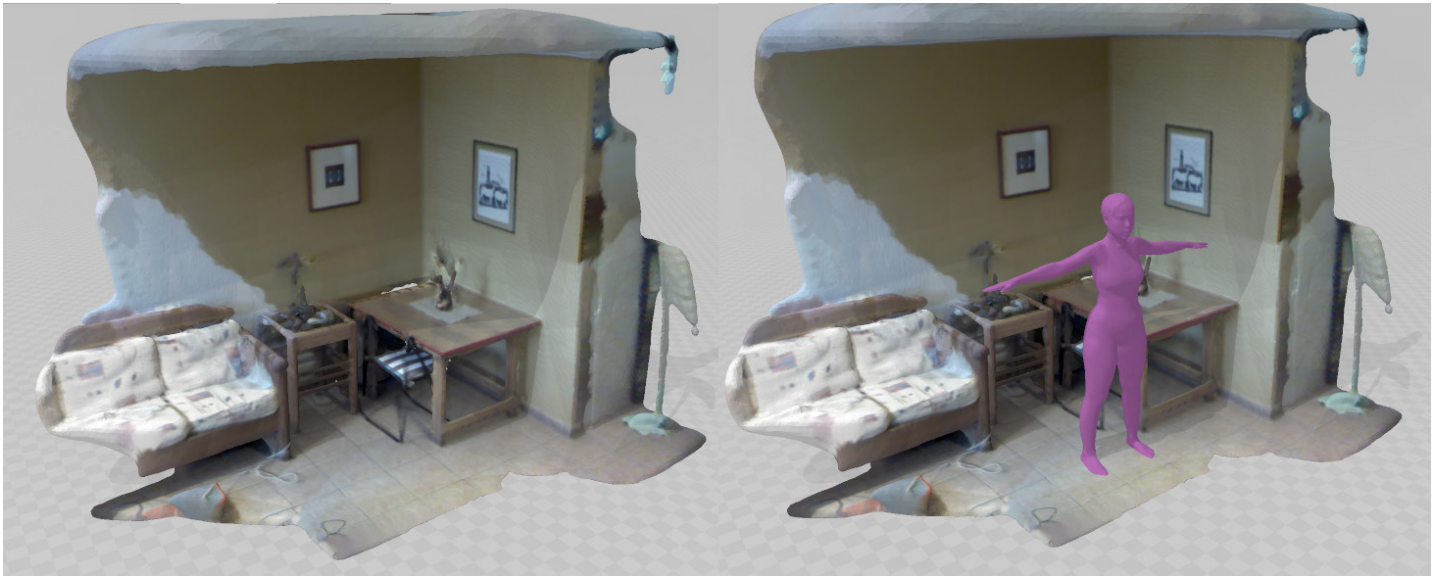
Imagen jj - Escaneo 3D de la sección de una habitación. Los resultados son de buena calidad, pero la complejidad de una escena grande requiere mayor poder de procesamiento, o equipo especializado como escáneres tipo Lidar. Fuente: Elaboración propia.
