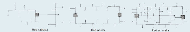
Possible configuraciones de la red de distribución. Fuente: Metodología para el desarrollo de calefacción geotérmica distrital mediante la rehabilitación de pozos petroleros con aplicación en Punta Delgada, región de Magallanes, 2018.
