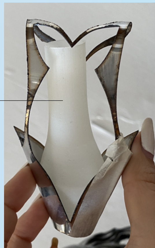
Figura 116. Diseño, corte y cilindrado armazón a escala. Elaboración propia.
