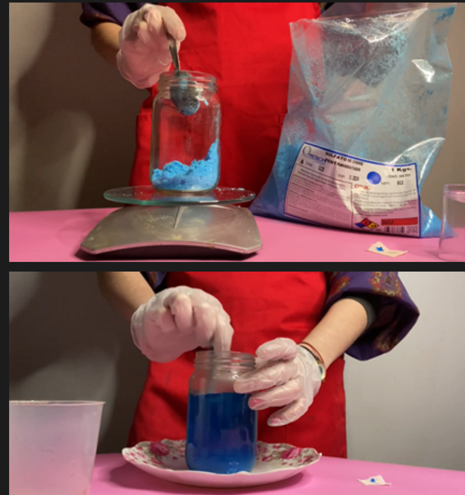
Figura 59. Paso 1 del proceso de cultivo de semillas para cristalización. Elaboración propia.
