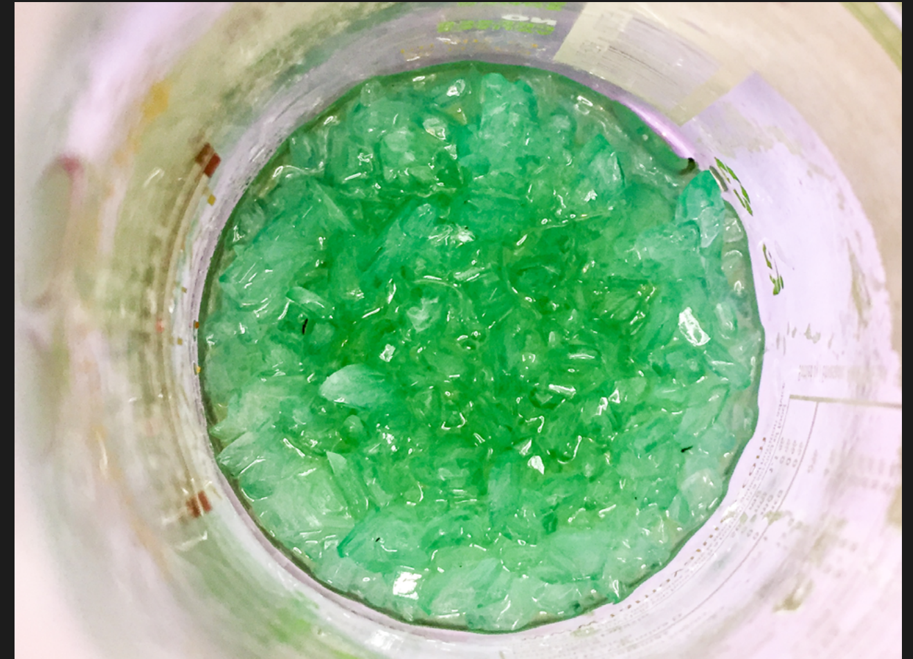
Figura 63. Obtención de semillas para cultivo de Sulfato de Hierro. Elaboración Propia.
