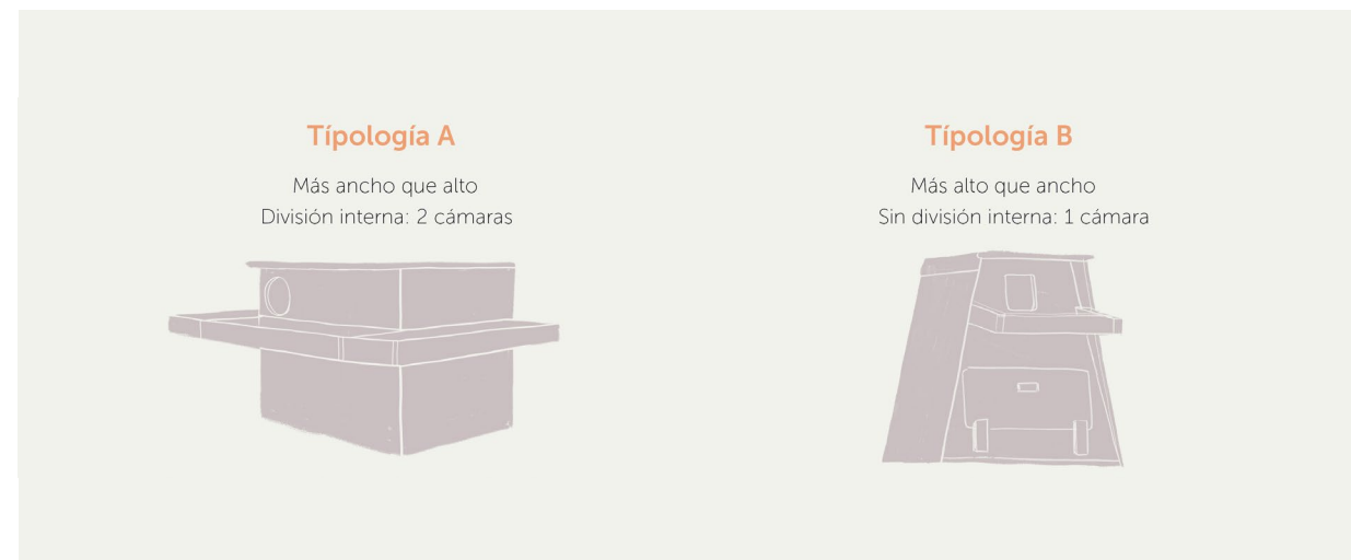
Figura 37. Representación de las tipologías de refugios anideros tipo “casa” y “caja”. Elaboración propia.
