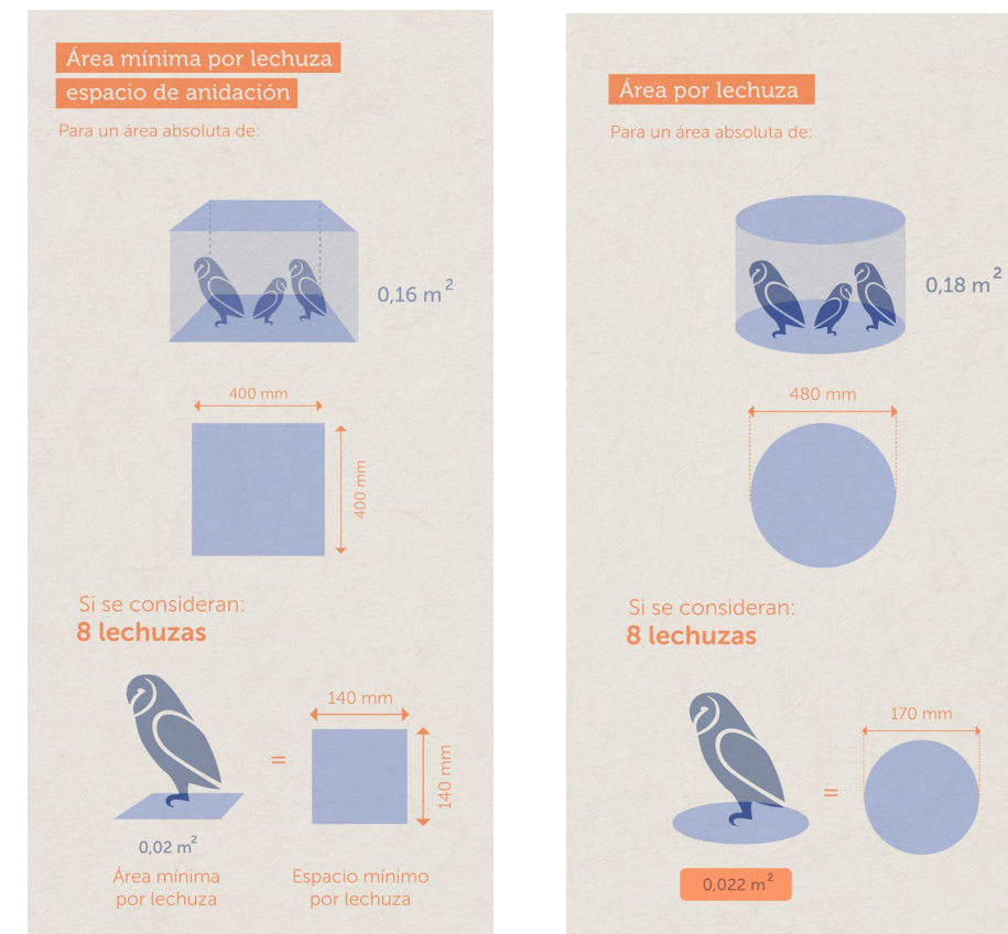
Figura 40. Área mínima para considerar en la base del espacio de anidación, según “The Barn Owl Trust”. (The Barn Owl Trust, 2021c). Elaboración propia.
