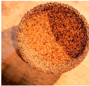
Figura 60. Material compuesto por cáscara de nuez de nogal. (Parodi Miranda, 2018)
