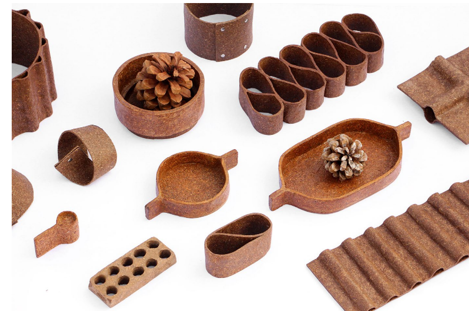
◀ Figura 59. Material compuesto biobasado con agujas de pino, creado por Gaurav MK Wali. Recupado de: https://eyesontalents.com/en/profiles/30138
