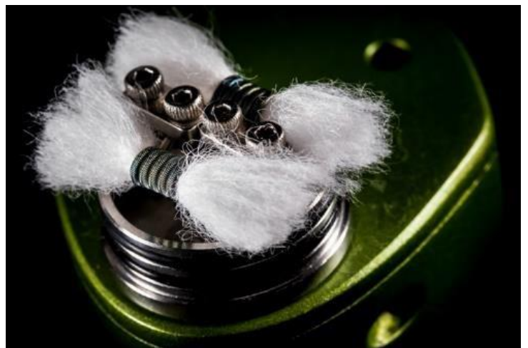
Imagen 15 Resistencia con alambres y algodón. El algodón se impregna con el líquido, para luego ser calentado por el alambre produciendo el vapor. Recuperado de: https://cutt.ly/iYBLsyy
