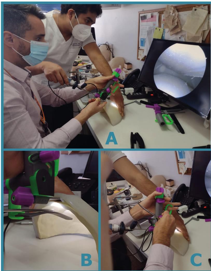
*Figura 103. Pruebas quinta validación, Neurocirujanos Dr. Roberto Vega y Andrés Goycoolea en prueba de uso general con inserción de instrumental en el espacio intracraneal y endoscopio (A); acercamiento del instrumento separando tejido superior evaluando posicionamiento del endoscopio (B); prueba de mecanismo de apertura y bloqueo.*
