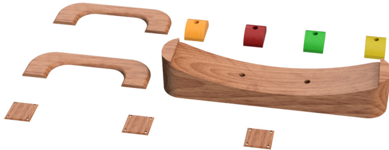
Imagen 62: Piezas para corte en CNC modelado en Fusion 360 (Francisca Moreno 2021)
