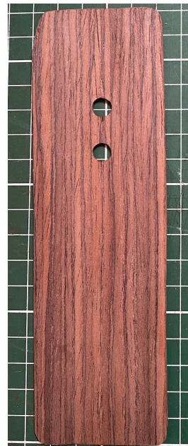
Imagen 40: Prototipo 4 de la tecla en chapas de Palissandro (Francisca Moreno 2021)
