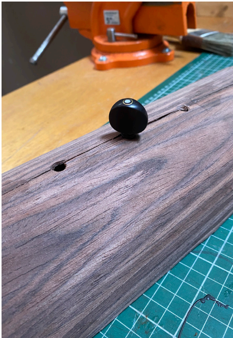
Imagen 44: Piezoeléctrico puesto entre las barras armónicas (Francisca Moreno 2021)
