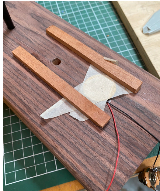
Imagen 43: Piezoeléctrico puesto entre las barras armónicas (Francisca Moreno 2021)
