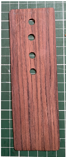
Imagen 39: Prototipo 3 de la tecla en chapas de Palissandro (Francisca Moreno 2021)
