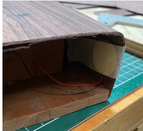
Imagen 42: Piezoeléctrico pegado al costado interior (Francisca Moreno 2021)
