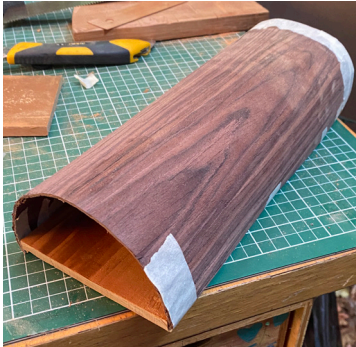
Imagen 29: Foto del primer prototipo de la caja de resonancia (Francisca Moreno 2021)
