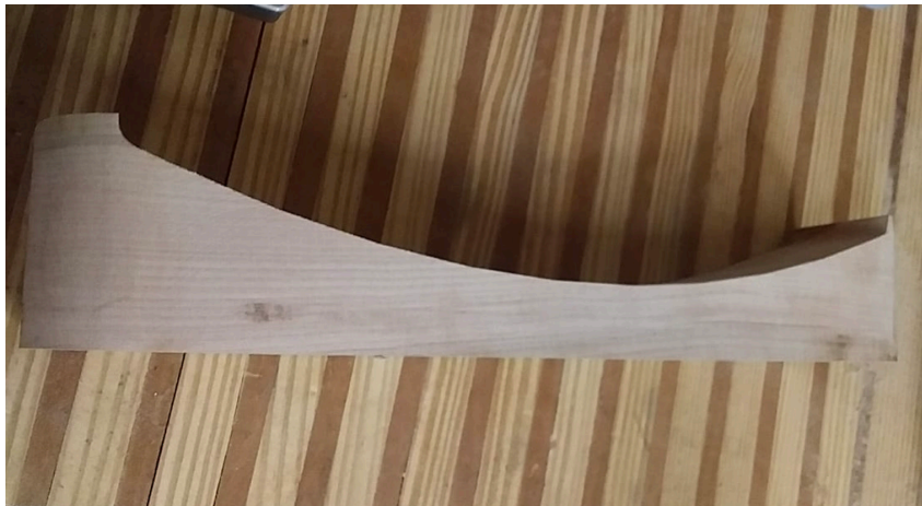
Imagen 64: Piezas central cortada en CNC router en lenga (Francisca Moreno 2021)
