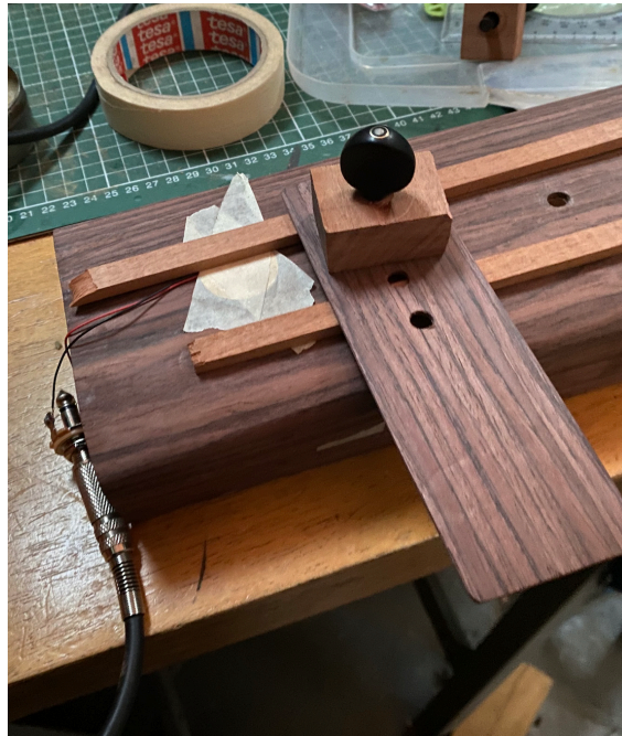
Imagen 45: Piezoeléctrico puesto entre las barras armónicas (Francisca Moreno 2021)
