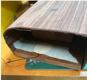
Imagen 39: Piezoeléctrico posado en la base (Francisca Moreno 2021)
