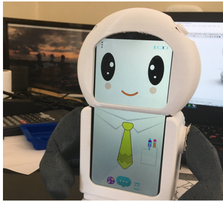
Figura 70. Montaje de brazos y celular con piezas impresas.
