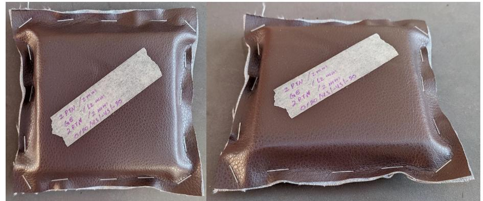
Figura 99: Probeta para ensayo GE/0.90.45.-45.-90
