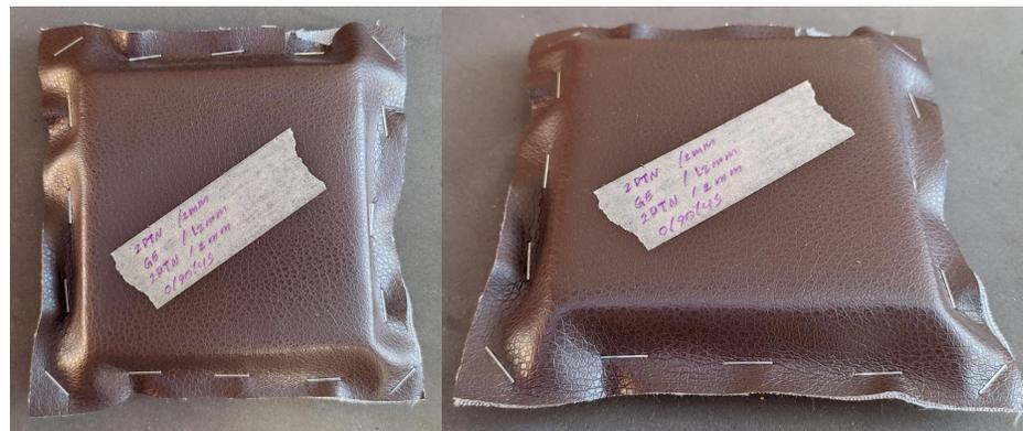
Figura 97: Probeta para ensayo GE/0.90.45
