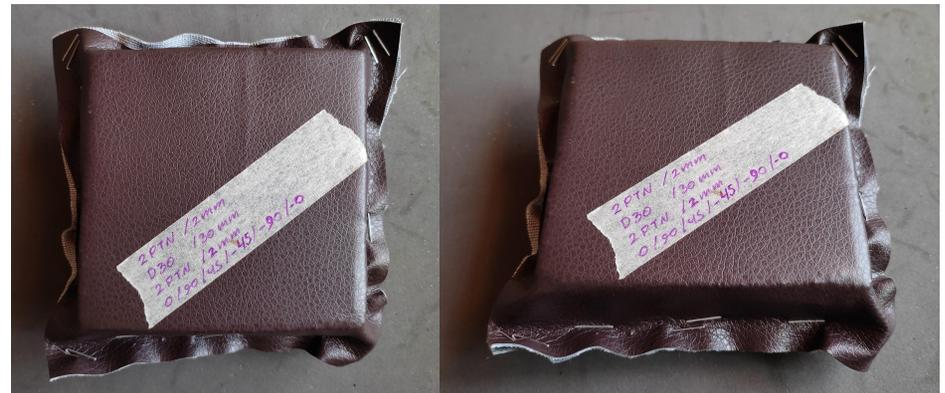
Figura 95: Probeta para ensayo ED30/0.90.45.-45.-90.-0
