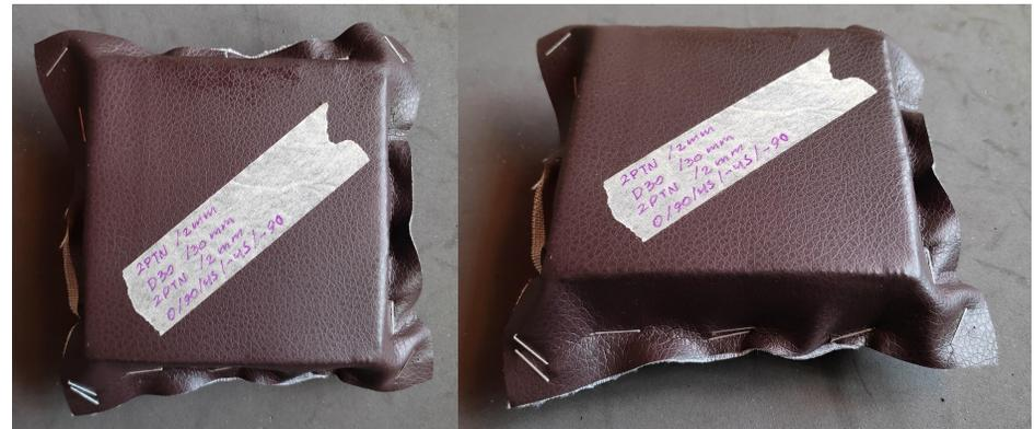
Figura 94: Probeta para ensayo ED30/0.90.45.-45.-90
