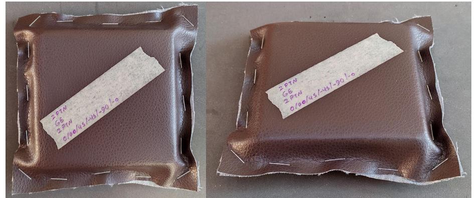
Figura 100: Probeta para ensayo GE/0.90.45.-45.-90.-0
