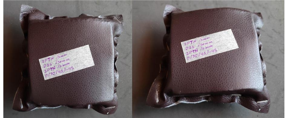
Figura 88: Probeta para ensayo ED25/0.90.45.-45
