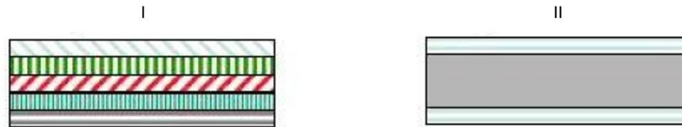
Figura 53: Compuesto laminar (I) y Compuesto Sandwich (II)
