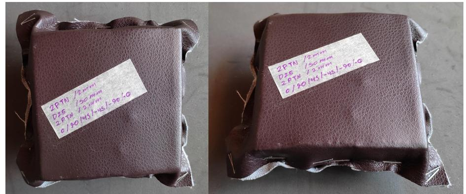
Figura 90: Probeta para ensayo ED25/0.90.45.-45.-90.-0
