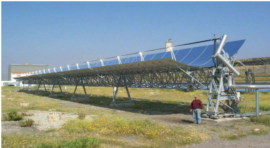
Figura 2.2: Prototipo extendido del colector EUROTROUGH 150 en operación en la plataforma solar de Almería[16].
