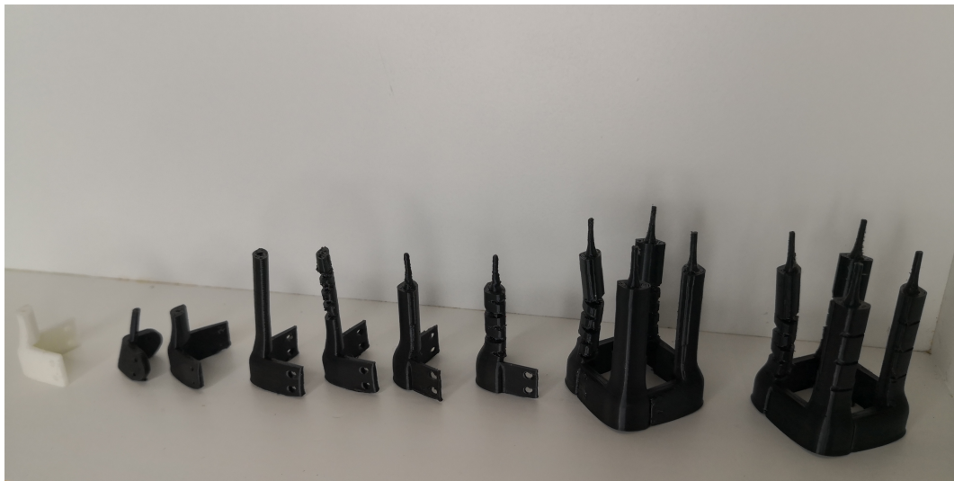
Figura 3.9: vértebras de las distintas fases de diseño.
