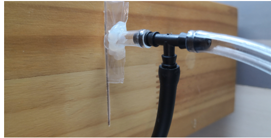
Figura 3.22: Punto de unión entre la bomba, el vacuómetro y el robot
