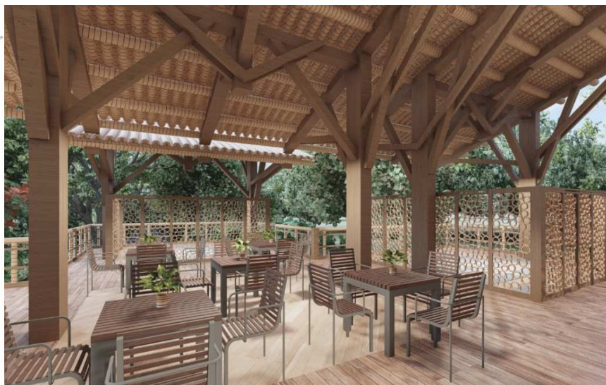
Fig. 3 y 4. Denise Rumbea. TFM. Centro de día para personas mayores en Ecuador. Sistema prefabricado realizado en bambú local, por industriales cercanos utilizando tecnología local. Máximo ahorro de energía y recursos junto con el máximo respeto ambiental y cultural.
