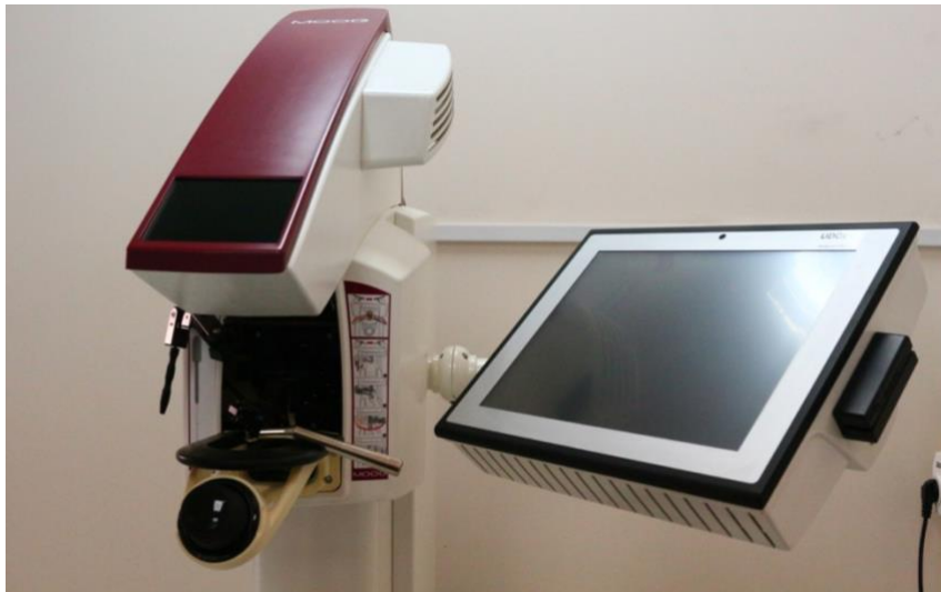
FIGURA 5: Vista frontal del Simodont® Dental Trainer. A la izquierda, el simulador háptico con el visor y el instrumental de simulación. A la derecha el Panel de control.
