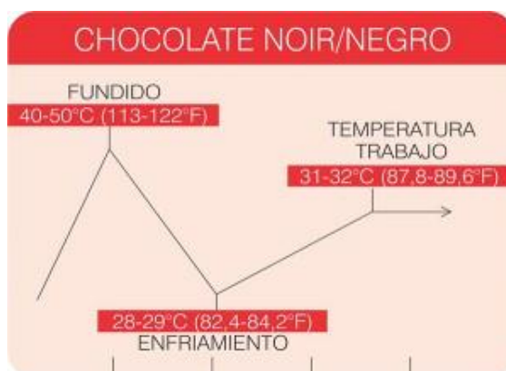
Fig 5. Programa de temperatura de atemperado proporcionado por el proveedor (Puratos Chile, 2017).
