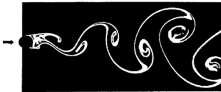
Figura 2.2: Vórtices transversales con número de Reynolds bajo [2].
