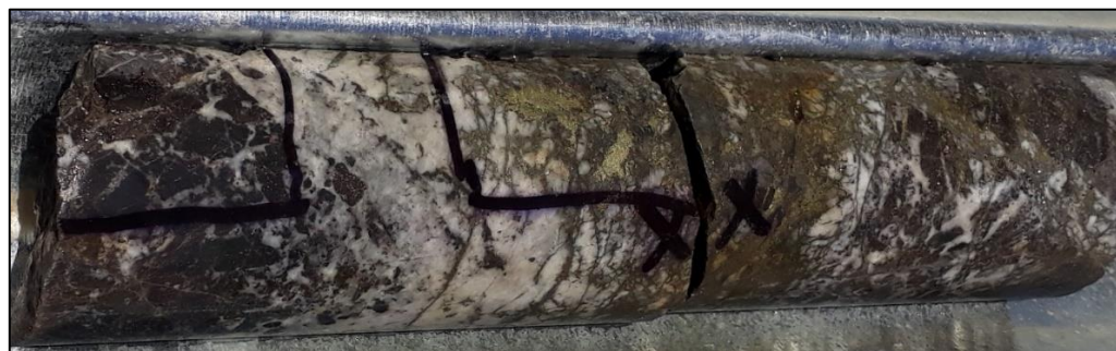
Figura 2.10. Fotografía de tramo de brecha hidrotermal (DDH-02; 198,50-198,70 m). Roca con textura brechosa y predominio de carbonato en la masa fundamental, la muestra presenta fragmentos de roca caja gris oscuro y mineralización de calcopirita (cemento).
