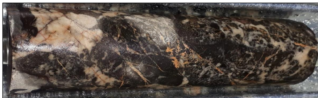
Figura 2.9. Fotografía de tramo de brecha hidrotermal (DDH-05; 65,40-65,60 m). Roca con textura brechosa con predominio de cuarzo en masa fundamental, la muestra presenta fragmentos de roca caja color gris oscuro (roca metamórfica).
