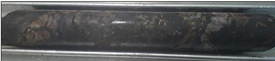
Figura 2.3. Fotografía de esquist brechoso (DDH-17; 58,0-58,30 m). Roca metamórfica que presenta textura brechosa, a partir de una matriz fina de color gris (metapelita) y cúmulos de composición más gruesos e irregulares (metarenisca) incluyendo cuarzo de segregación.
