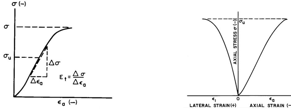
(a) Esquema método medición Módulo de Young. (b) Esquema deformación diametral y axial  $\sigma_u$  representan el 50 % del esfuerzo peak  $\sigma$
