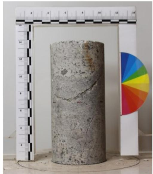
(d) GRD3 después de ensayo
