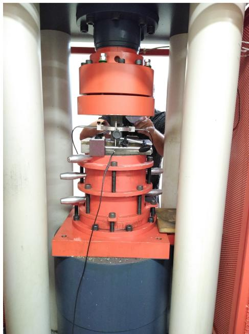
Figura 2.2: Prensa servo-asistida MES300 con muestra montada.
