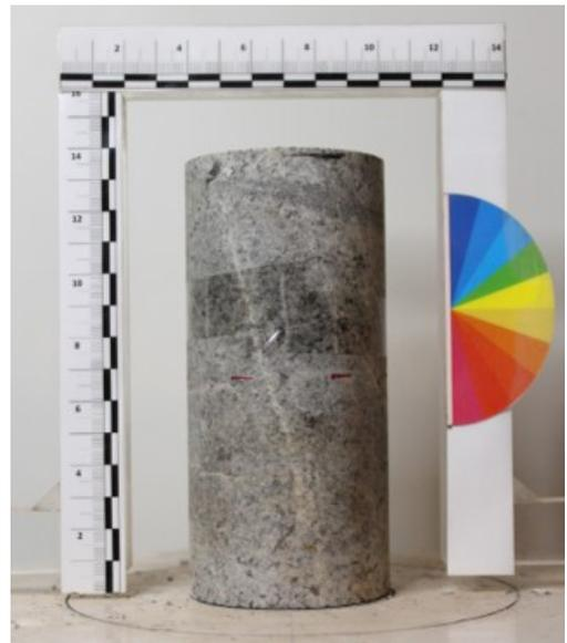
(d) GRD10 después de ensayo
