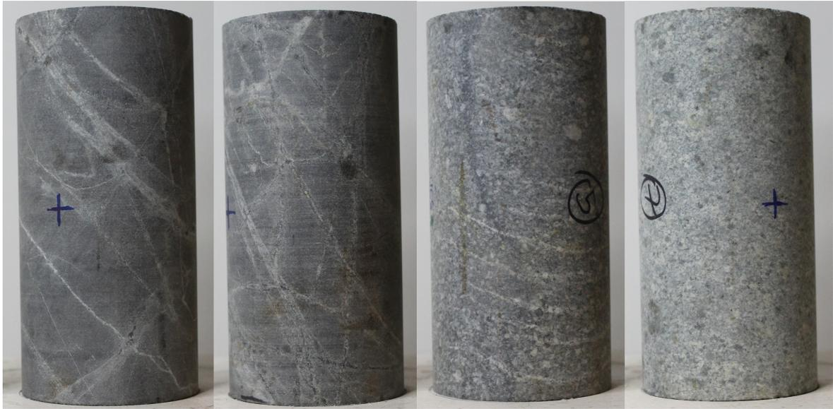
Figura 3.4: Textura y estructuras en muestras Gabro (2 probetas de la izquierda) y Dioritas (2 probetas de la derecha) provenientes de depósito tipo P+orfidó Cuprífero.
