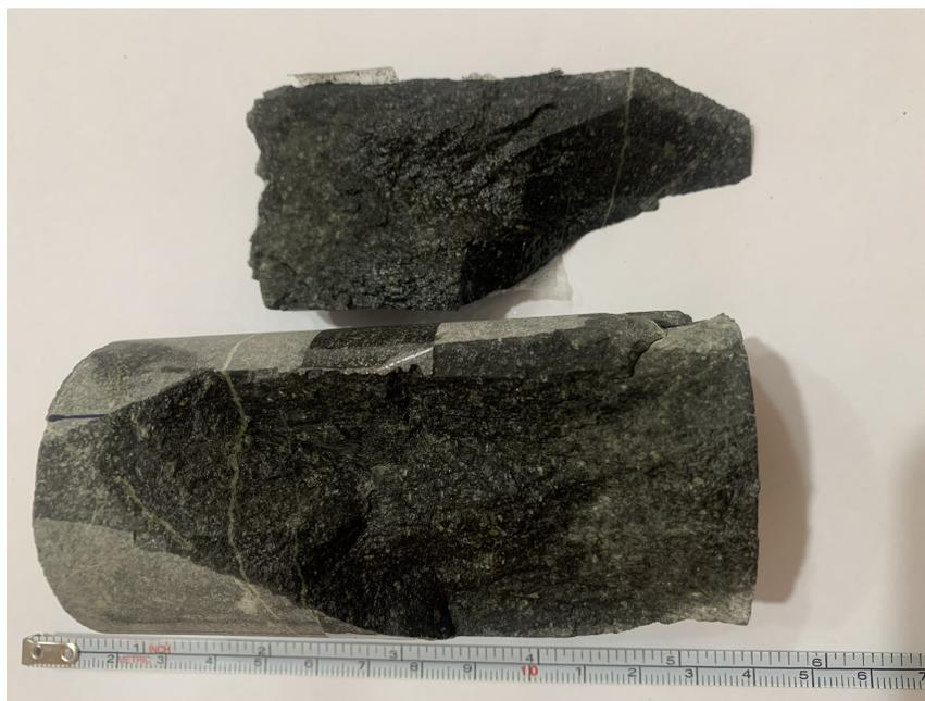
Figura A.3: Muestra de mano Andesita proveniente de depósito tipo Vetiforme.
