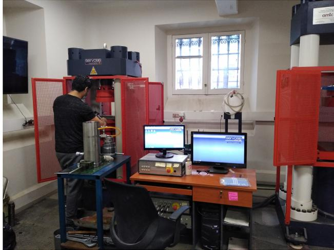
Figura 2.1: Prensa servo-asistida MES300 (izquierda) y computador con software *Servosis* 2020 (derecha).
