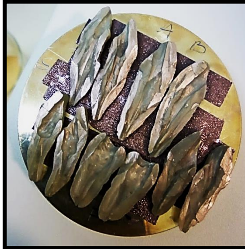
Figura N°16. Dientes seccionados longitudinalmente, secados a punto crítico y metalizados con oro sobre porta muestras de aluminio.
