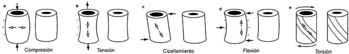
**Figura 6. Tipos de deformación básicas de un cuerpo (modificado de Lieberman, 2011).**
