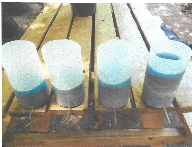
Figura 1: Ensayo a pequeña escala para estimar el tiempo de descarga según las distintas distribuciones de arena.
