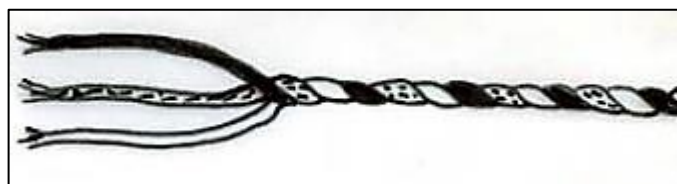
Figura 15 – Representación esquemática de un hilado jaspe (extraído de Agüero, 2015, Anexo 3, vi).
