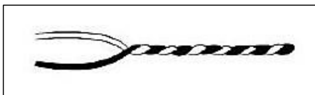
Figura 14 – Representación esquemática de un hilado molinés (extraído de Agüero, 2015, Anexo 3, vi).
