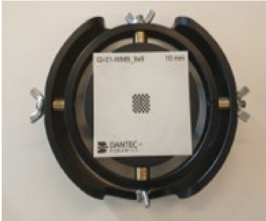
Figura 3.4: Dispositivo empleado para realizar la calibración de las muestras. Permite definir un espaciamento y distancias relativas.
