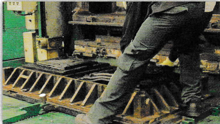
Figura 10: Uso de caucho laminado en moldes de placas polimet
