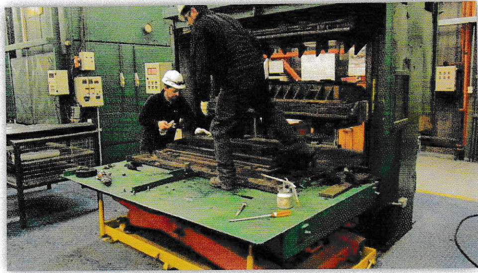
Figura 17: Preparación de molde con materias primas, acero y caucho
