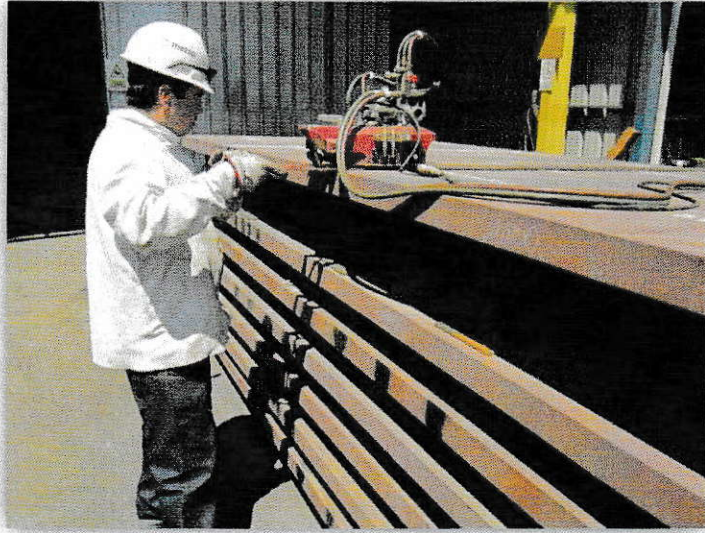
Figura 12: Corte de planchas de acero antiabrasivo
