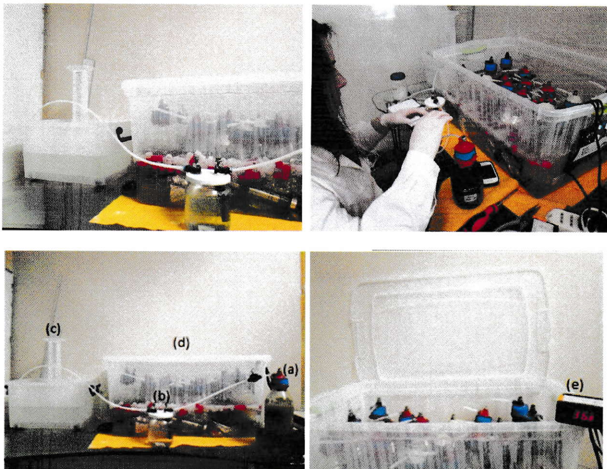
Figura 14. Montaje de ensayo de degradabilidad, (a) Agitador magnético y ensayo, (b) Lavado de biogás generado con una solución alcalina de NaOH al 15%, (c)Medición de biogás por desplazamiento de agua, (d) Baño termostático, (e) Termómetro digital.
