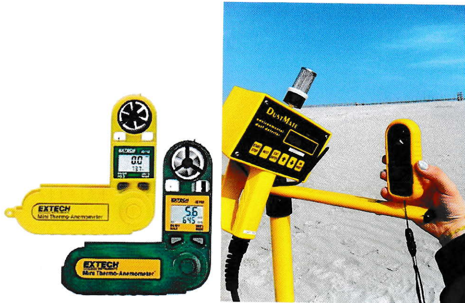
Figura 34. Anemómetro, instrumento de medición de velocidad puntual de los vientos.
