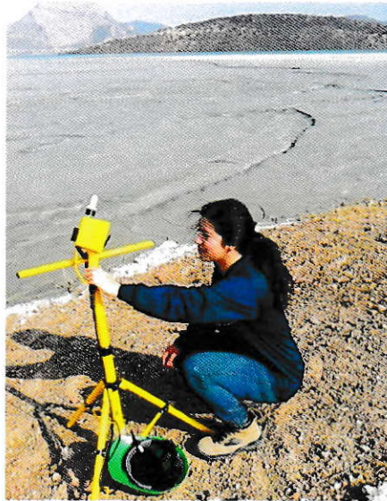
Figura 31. Equipo Dustmate para la determinación de material particulado (PST, PM_{10} , PM_{2.5} , PM_1 ).
