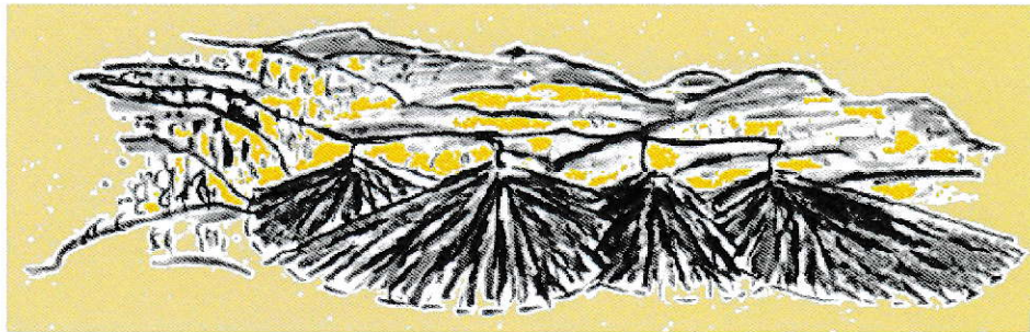
Figura 9. Método de desplazamiento Discontinuo de relaves espesados.
