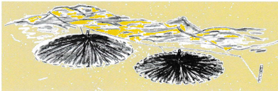
Figura 10. Depósito domo por sectores de relaves espesados.
