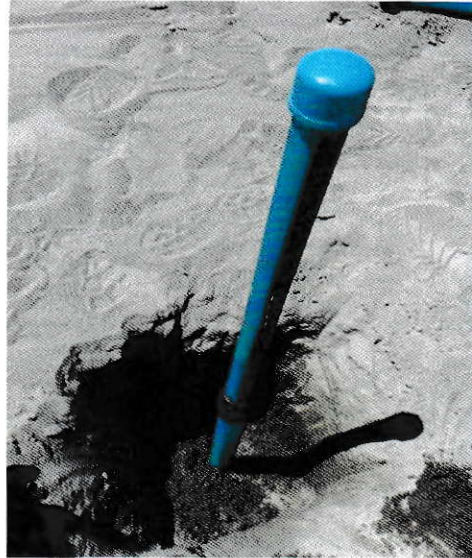
Figura 28. Representación de trampa de saltación pasiva (trampa de Leatherman).
