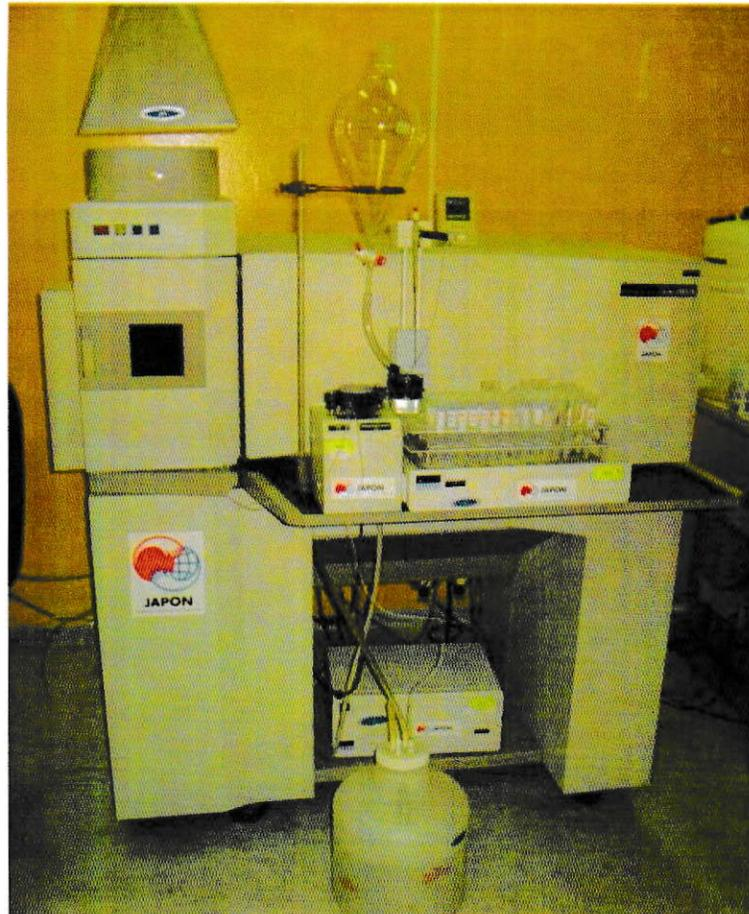
**Figura 6.** Espectrómetro de plasma inductivamente acoplado Perkin Elmer modelo Optima 3300 XL
