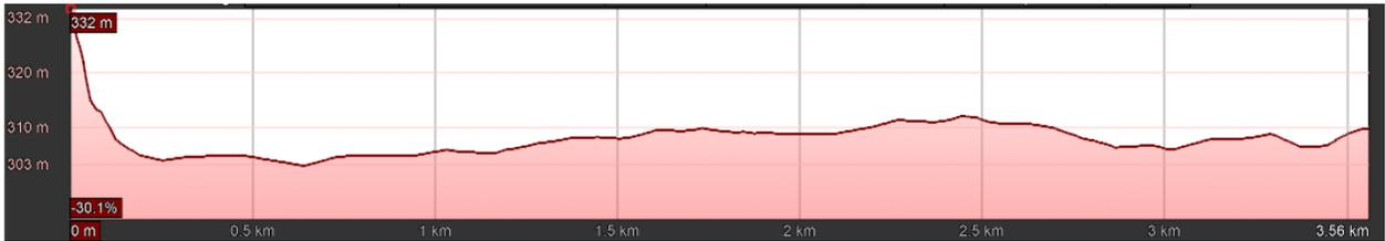
Figura 3.3: Perfil longitudinal correspondiente al tramo de recolección del APR Lo de Cuevas
