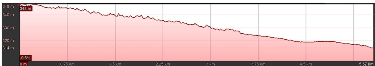
Figura 3.7: Perfil longitudinal correspondiente al tramo de recolección del APR California junto al APR Rinconada de Doñihue
