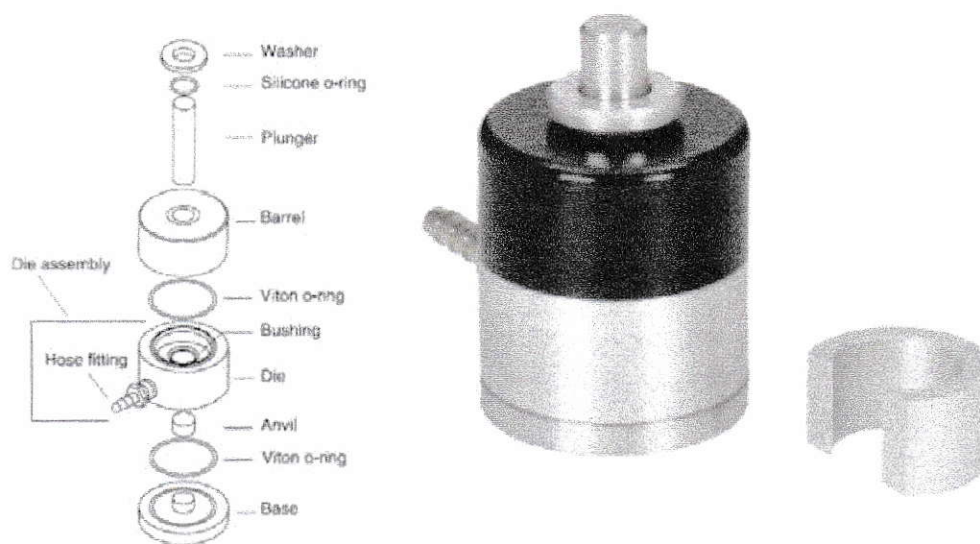
Figura 12: Representación de pastillero utilizado para la preparación de muestras IR-FT.
