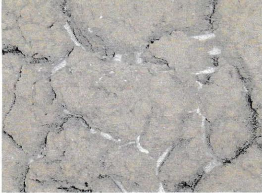
**Figura 15:** Prueba de deshidratación lodos, Día 4: Se observa que el lodo está mucho más compacto y que ha perdido gran cantidad de agua. Masa final es 12 Kg.
