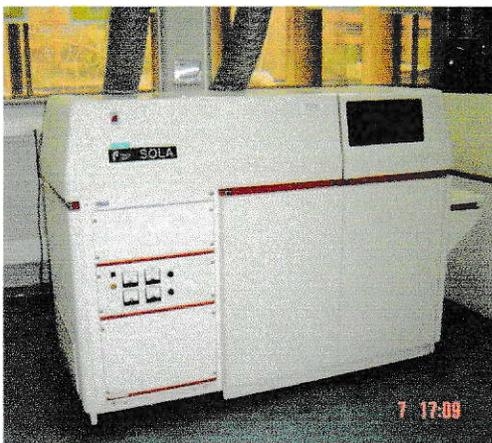
Figura 13: Equipo ICP/MS Finnigan modelo Sola System 266.
