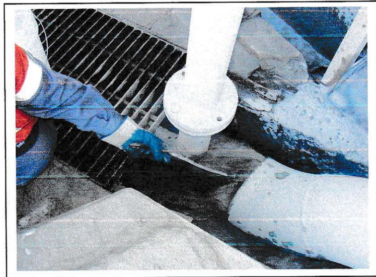
Figura 26. Lugar de muestreo de concentrado flotación poroso.
