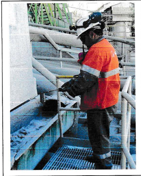
Figura 27. Lugar de muestreo de concentrado flotación caliza.
