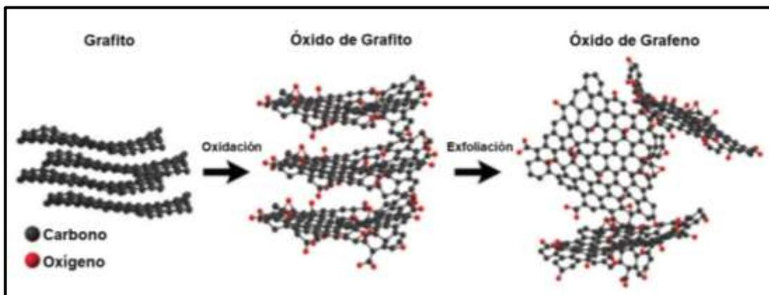
Figura 1.2. Mecanismo simplificado para obtener láminas de GO. Adaptado de (Amieva, E. J. C., López-Barroso, J., Martínez-Hernández, A. L., & Velasco-Santos 2016).
