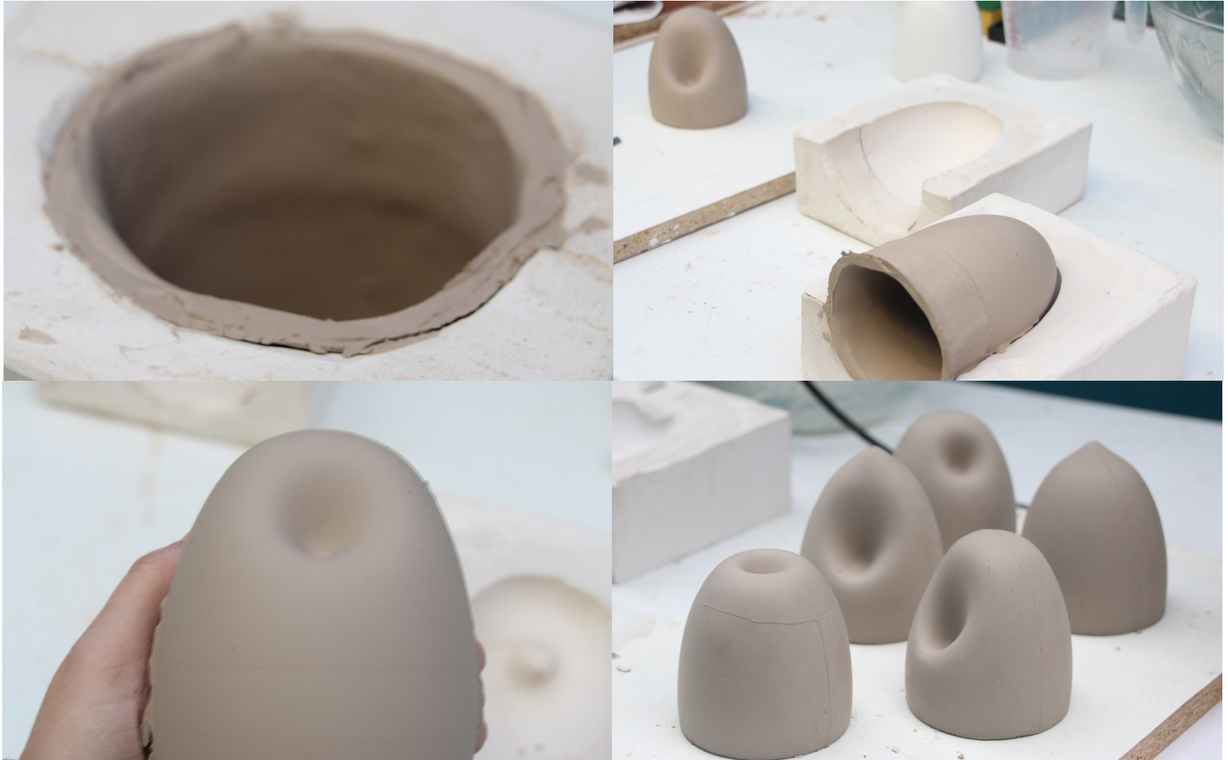
Figura 56. Apertura de moldes. Autoría propia.
