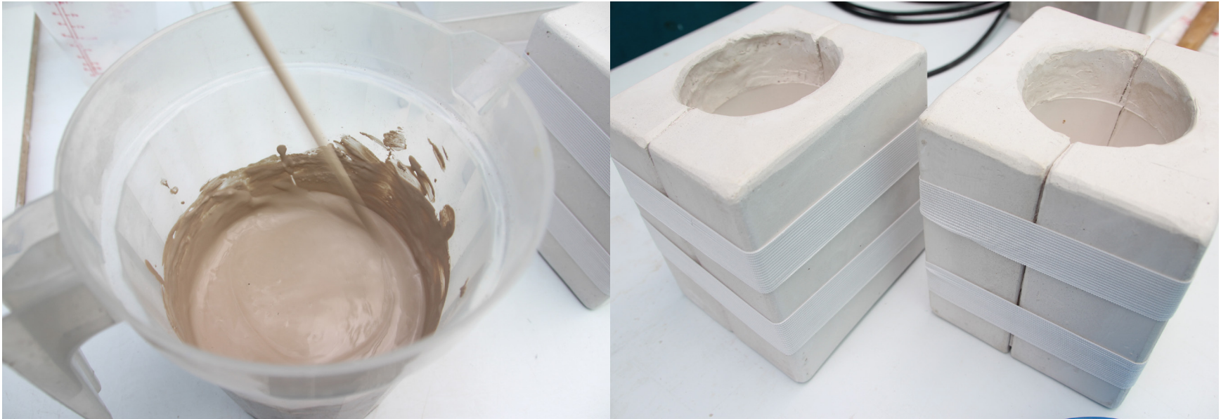
Figura 54. Preparación para el vaciado de pasta de colada. Autoría propia.
