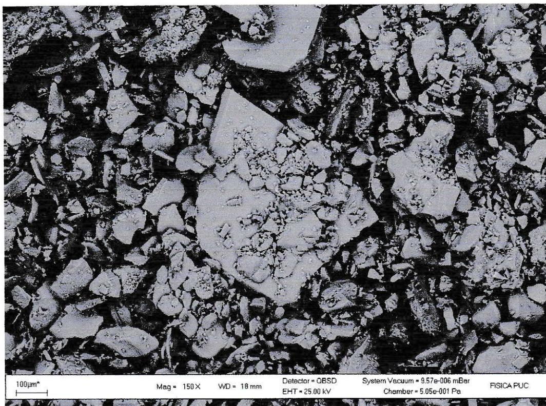
Figura 18. Cristales de molibdato de sodio obtenidos por cristalización extractiva.
