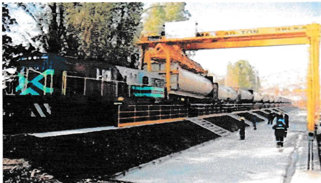
Figura 32: Transporte vía tren de celdas con residuos compactados
