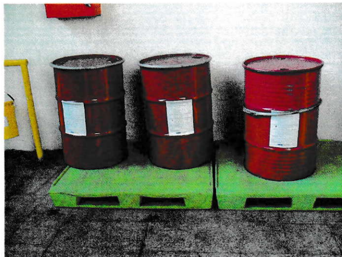
Tambores para Residuos Peligrosos
