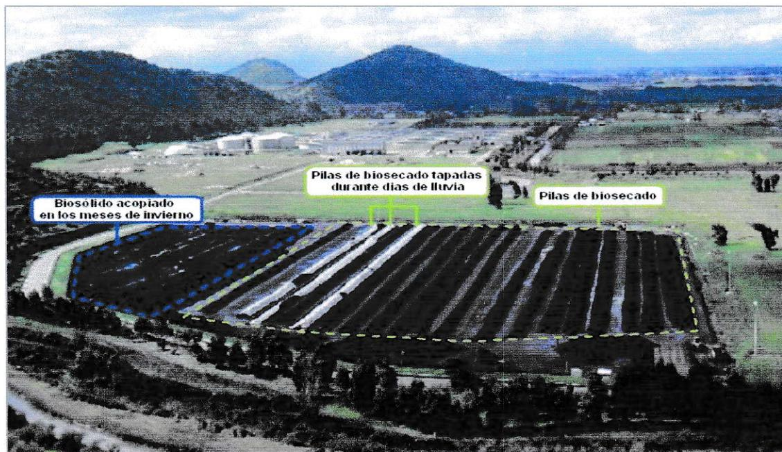
**Figura 12.** Cancha de secado PTAS El Trebal durante proceso de biosecado. Agosto 2007. (Maturana, 2007)
