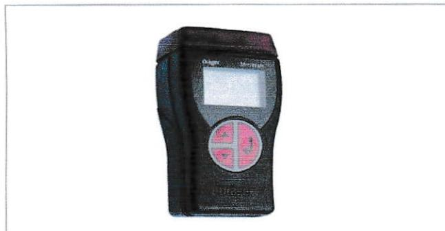
**Figura 16.** Equipo de monitoreo de gases con sensores electroquímicos. (Draeger Safety Inc, 2008).
