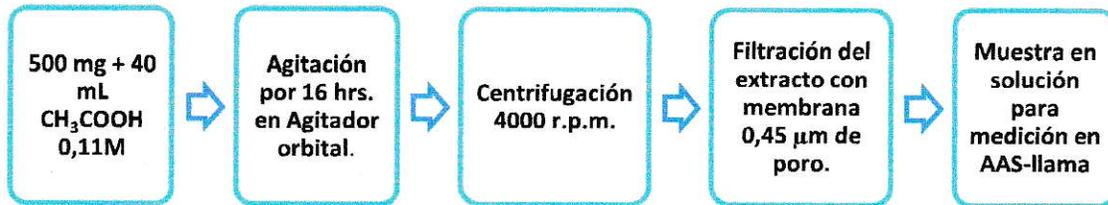
Figura 23: Diagrama de digestión de sedimentos para fracción lábil.
