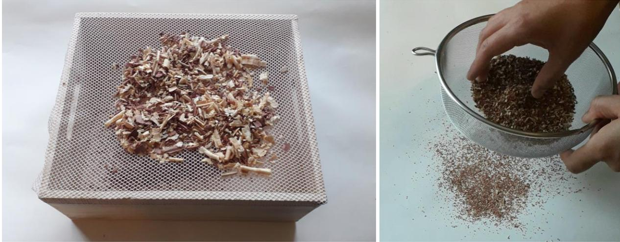
Figura 32: Tamices utilizados para definir el tamaño de la viruta del material compuesto. Elaboración propia
