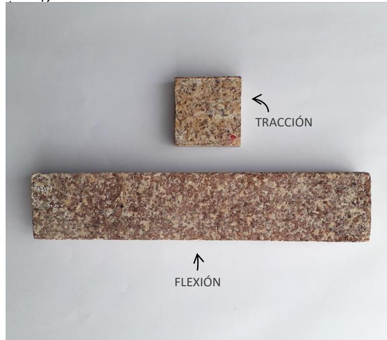
Figura 49: Tipo de probeta usada para ensayos de flexión y tracción. Elaboración propia.
