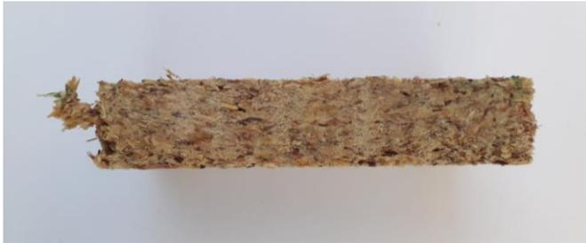
Figura 59: Corte con sierra caladora para muestra con 60% de viruta. Vista frontal. Elaboración propia.
