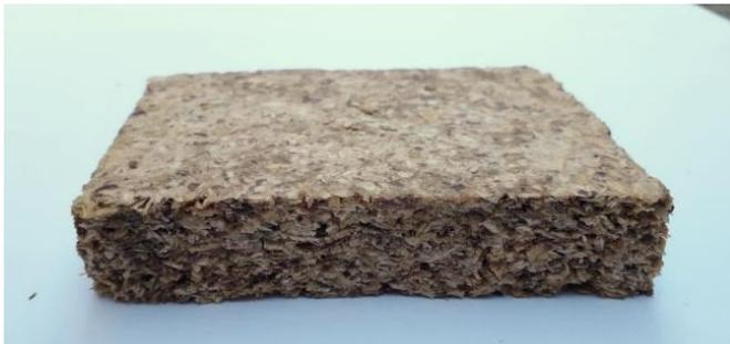
Figura 61: Corte con sierra circular para muestra con 60% de viruta. Vista isométrica. Elaboración propia.
