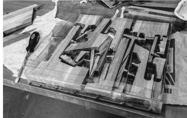
Figura 24: Molde que contiene los trozos de madera en desuso para ser aplicada la resina. (Fuente: Yanko Design)
