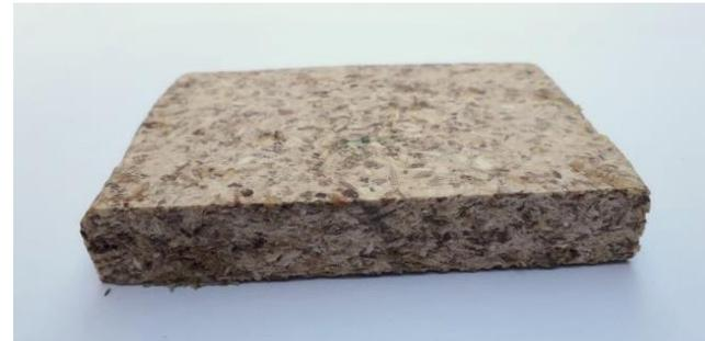
Figura 62: Corte con sierra circular para muestra con 50% de viruta. Elaboración propia.
