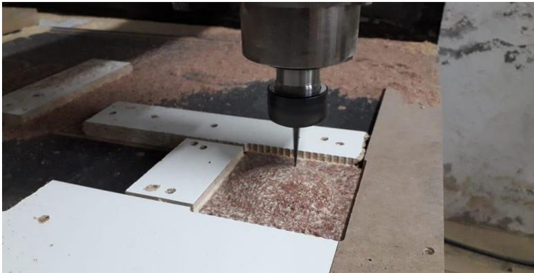
Figura 52: Prueba del material en Router CNC. Elaboración propia.
