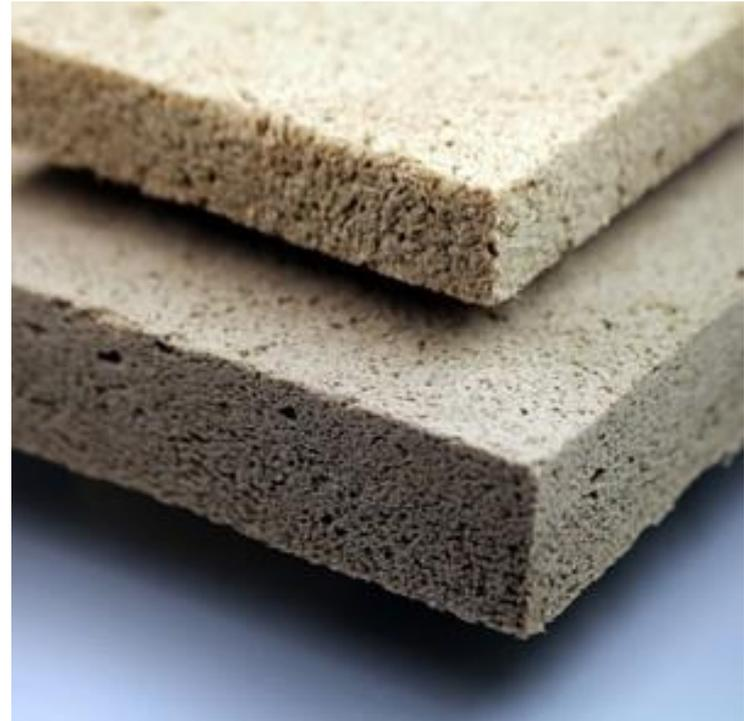
Figura 29: Espuma celulósica para aislamiento térmico (Arinni Estudio, s.f.).
