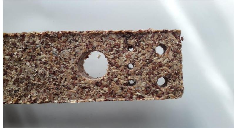
Figura 63: Perforado en muestra con 60% de viruta.
