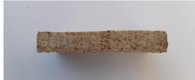
Figura 60: Corte con sierra caladora para muestra con 50% de viruta. Vista frontal. Elaboración propia.
