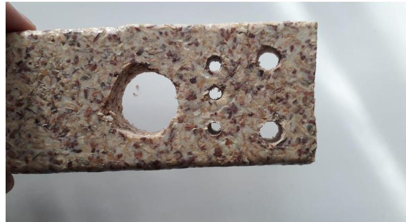
Figura 64: Perforado en muestra con 50% de viruta.
