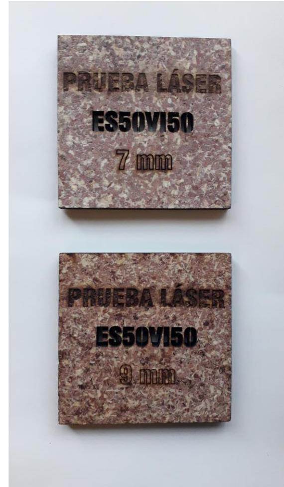
Figura 78 Resultado de muestra en corte láser.
