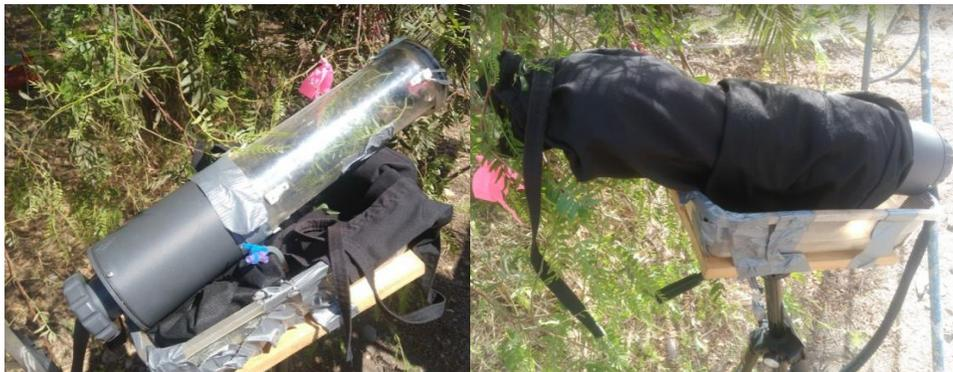
Figura 9. Sistema de medición de fotosíntesis. [a] Lectura de  $\text{CO}_2$  con fase luminosa, [b] lectura de respiración en oscuridad.
