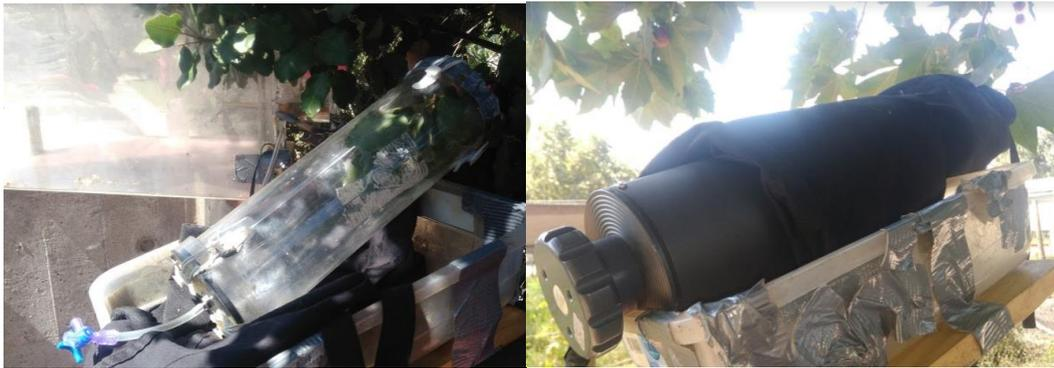
Figura 11. Cámara circular sellada con aire concentrado en su interior[a], cámara circular con luz bloqueada[b].
