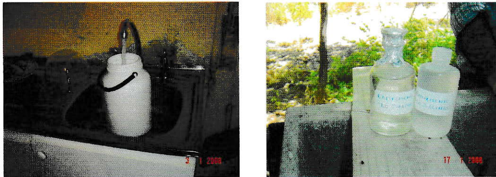
Figura 23: Sistema de toma de muestras de las aguas destinadas a consumo de los campamentos del convenio ambiental CONAF – División El Teniente, de acuerdo a lo estipulado en la NCh. 409.
