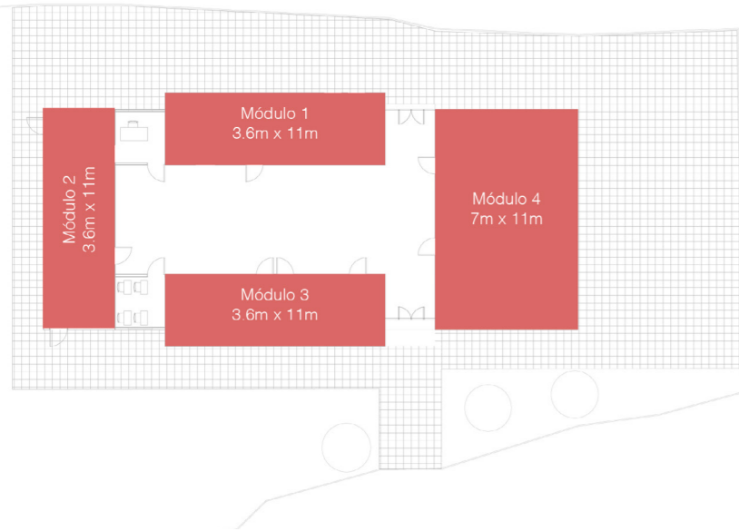
Fig. 84 Disposición y dimensiones de contenedores Elaboración propia
