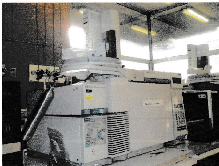
Figura 14: Cromatógrafo de gas HP 6890 con Detector de Masa Específico 5973.
