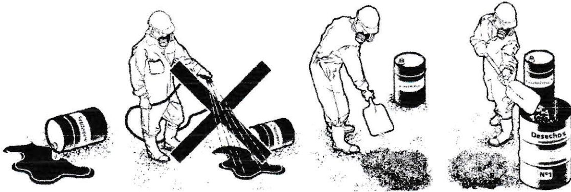
Figura 8: Control de derrames.
