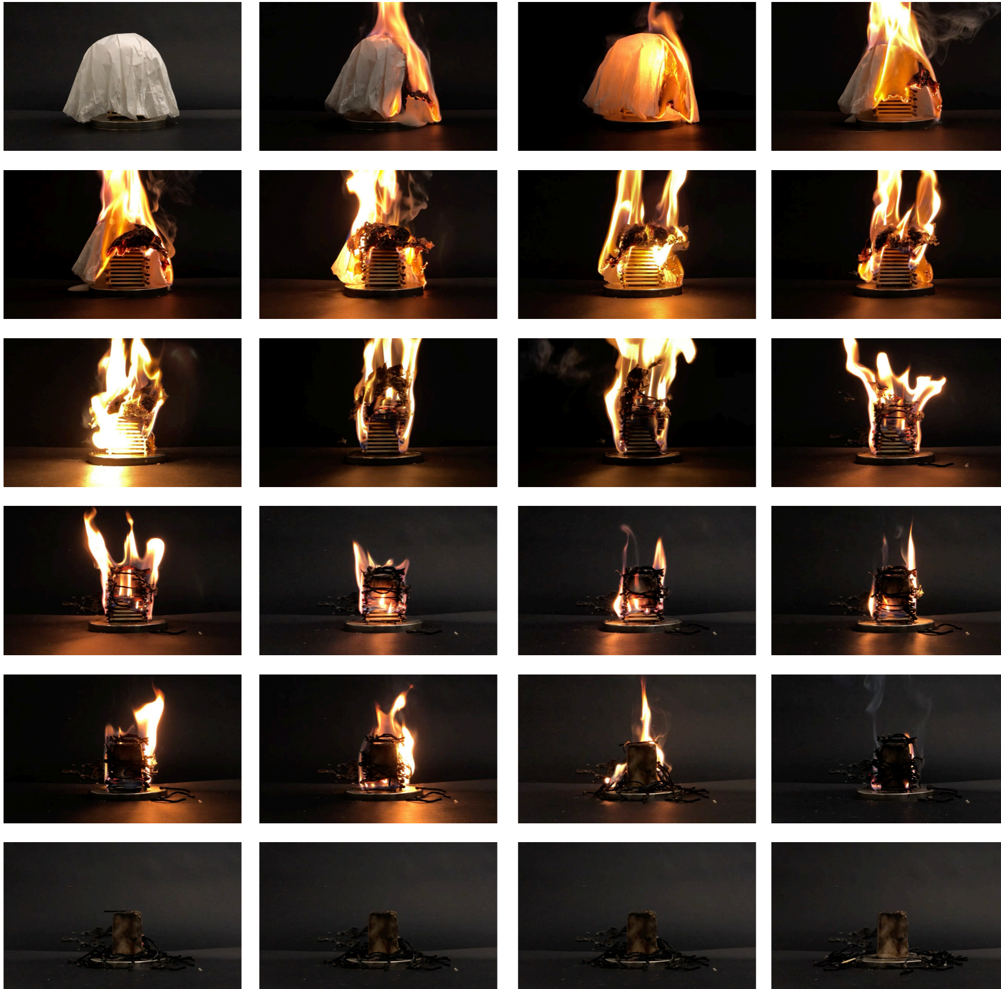
Maqueta de experimentación, poniendo a prueba Las 3 Capas. Capa 1, papel mantequilla Capa 2, fósforos Capa 3, arcilla
