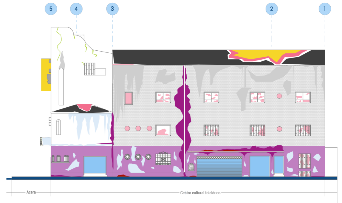
Análisis de patologías vista fachada este. Fuente: González, Y. (2021)
